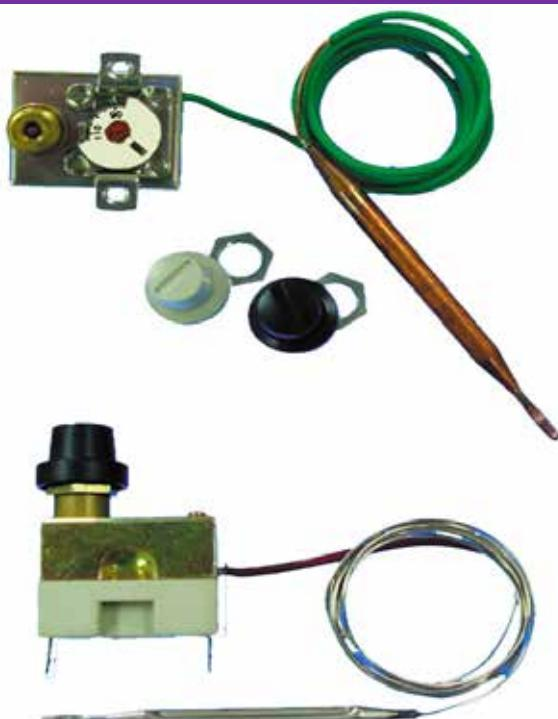
Termostatos limitadores unipolares a ruptura brusca del contacto, con rearme manual y seguridad positiva en caso de rotura del capilar.
