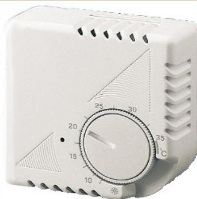
Termostato de ambiente a bimetal con resistencia aceleradora de ciclos y termistor para compensar la temperatura ambiente, precisa de conexión a 220V. 10A. Calefacción/Acondicionamiento, diferencial 0,5 °C.
