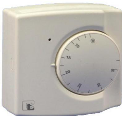
Termostato de ambiente bimetal con resistencia aceleradora de ciclos y termistor para compensar la temperatura ambiente por lo que precisa de conexión a 220V.
