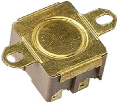
Termostato limitador **bipolar** para el control de la temperatura a contacto con rearme automatico, a ruptura brusca.
